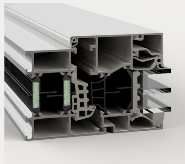
Abb. 2: ALPET® mit Fahne und T. Durch die Fahne wird der Hohlraum unterteilt und die Luftkonvektion reduziert, was zur Einsparung von Energie und zur Senkung der Heizkosten führt.
