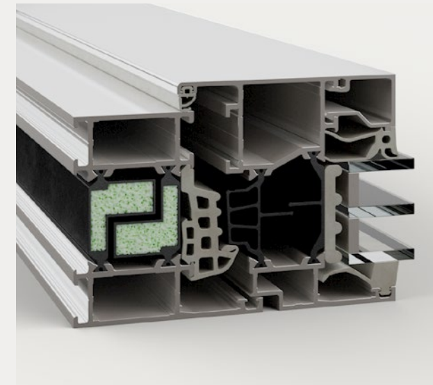
Abb. 3: ALPET® Hohlraum gefüllt. Es müssen keine isolierenden Einschieblinge eingebaut werden, dadurch können Arbeitsschritte eingespart werden. Verschiedene Profiltypen sind mit demselben ALPET® realisierbar.
